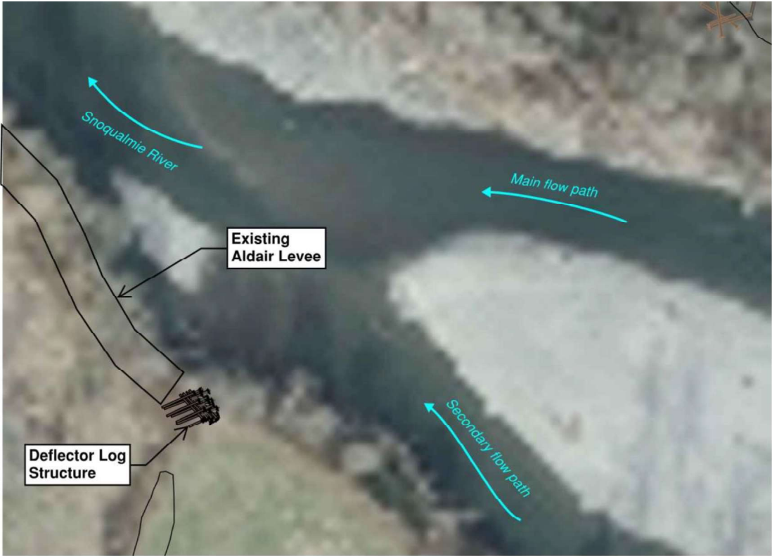
Figure 5 – Left bank deflector ELS
