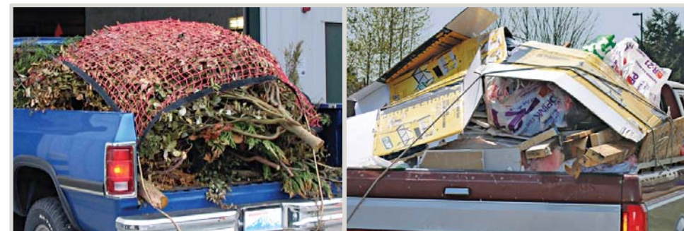
¡Estas cargas no están bien aseguradas! La soga y la malla que se ven en las imágenes no son adecuadas para asegurar que nada se salga del vehículo cuando esté en movimiento.
