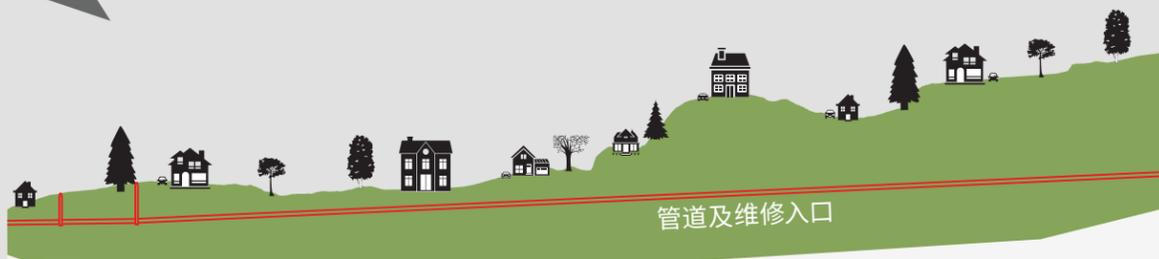
4. 挖渠机将建造管道最长的部分并铺设与地下深处。两端的井槽让承包商能启动(#1)及取回(#7)挖渠机。
