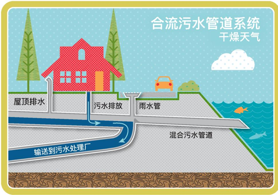
之后，工程师们建造了污水处理厂，将其净化后再排放到环境中。他们建造了大型管道，称之为“合流污水管道”，将所有这些水输送到污水处理厂。
